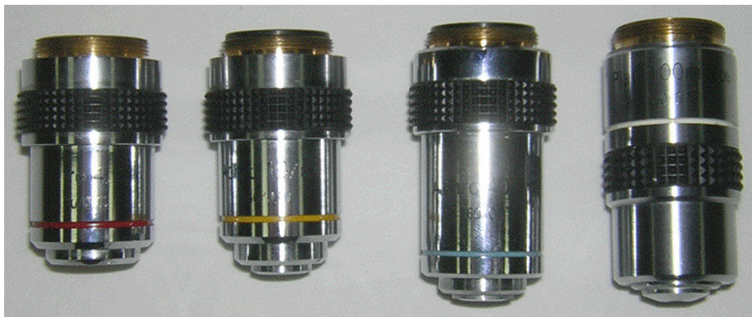
Figura 10: Cuatro objetivos con diferentes aumentos. ¿Sabrías de que aumentos se trata, basándote en el color de sus anillos?. Lee el párrafo siguiente.
